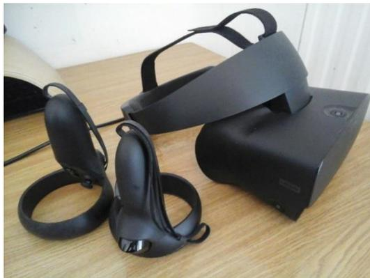
*Abbildung 4: Oculus Rift S (ein PCVR-Headset) mit beiden Controllern*
