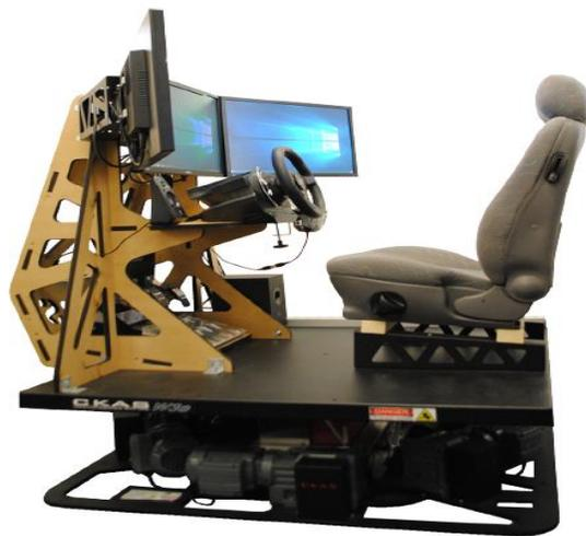
*Abbildung 6: Cockpit Mockup auf der Motion Plattform [15]*
