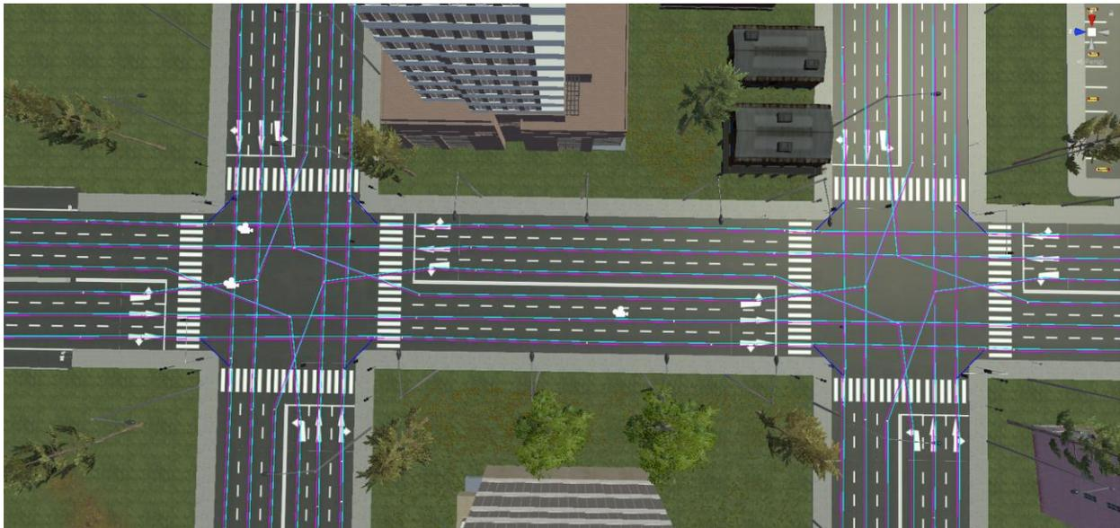
**Abbildung 28: Visualisierte Wegpunkte für computergesteuerte Autos**
