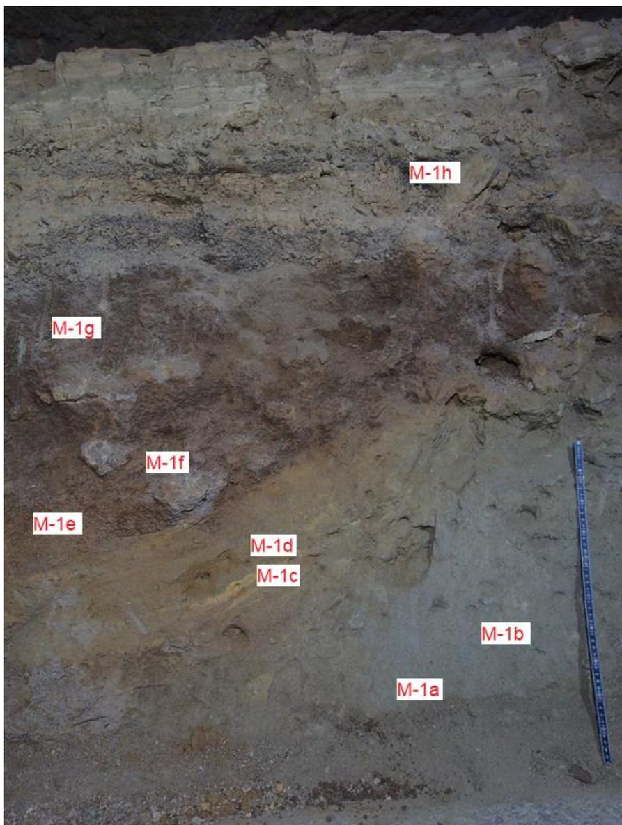
Abbildung 22: Profil M-01 mit markierten Probeentnahmepunkten.
