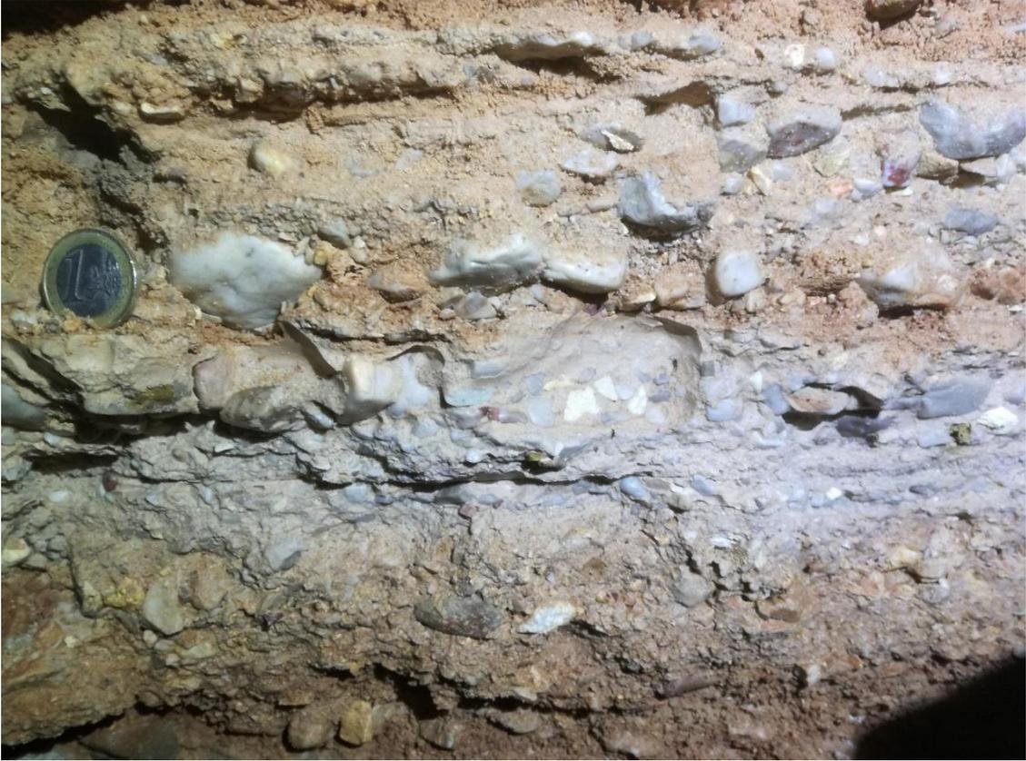
*Abbildung 49: Detailaufnahme der Konglomeratwand M-16 (Verfestigung durch Karbonat).*
