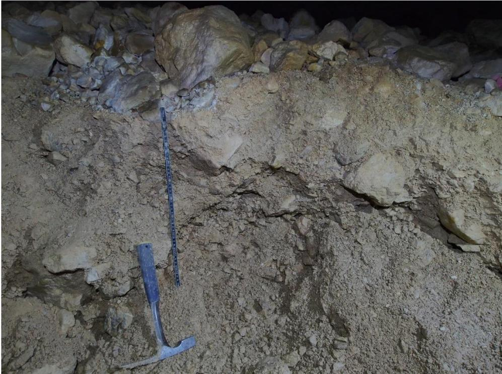
Abbildung 51: Detailansicht des Untersuchungspunktes E-02, vermutete Moränenablagerung.
