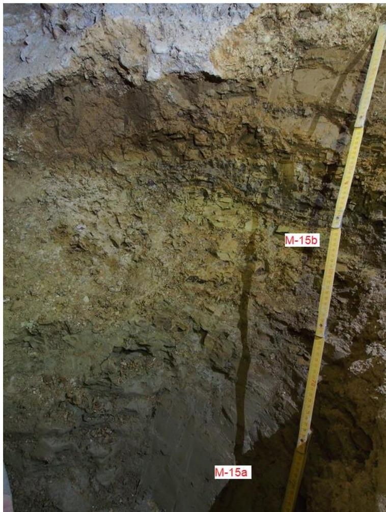
Abbildung 44: Detailansicht des Profilpunktes M-15 mit markierten Probenentnahmestellen.
