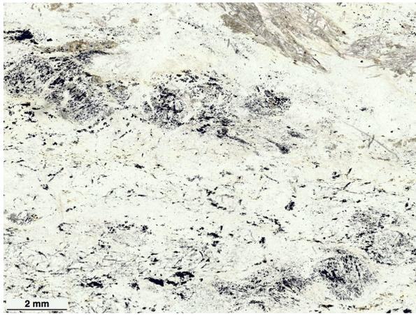
(a) Serpentin, 19/36: In einer feinkörnigen Masse aus blaugrünlichem Srp und Chl sind Tlc und Srp Pseudomorphosen nach Px zu erkennen. Gut ist auch die Bildung von opaken Phasen und Srp in Spaltrissen zu erkennen. Eine Einregelung der ehemaligen Px ist noch angedeutet.
