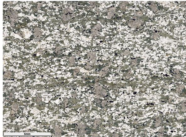
(b) Amphibolit, 19/28: Die Foliation bildenden Hbl-Aggregate liegen in einer Matrix aus Plg und Qtz verteilt. Ein Lagenbau ist kaum zu erkennen. Viele, eher feinkörnige Grt-Kristalle sind mehr oder weniger gleichmäßig verteilt, Risse sind auch hier vorhanden. Opake Phasen (Ilm, teils mit Kernen aus Rtl) sind häufig.
