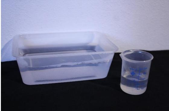
Abbildung 1: Versuchsaufbau bestehend aus einem Behälter, gefüllt mit 500 ml Wasser und einem kleinen Messbecher zum Abschöpfen des Wassers.
