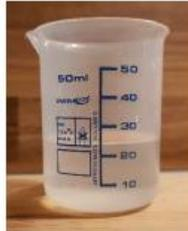
Du kannst nur so gut messen, wie es dein Messgerät erlaubt. Daher musst du dich entscheiden, ob sich das Wasser näher bei der oberen oder unteren Linie befindet.
