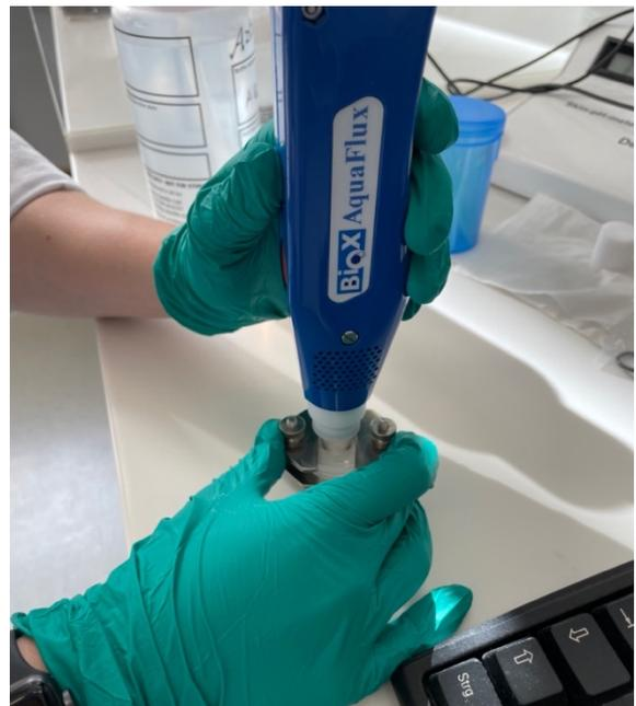
Abbildung 45: Messung des TEWL durch Aufsetzen auf die Franz-Zelle mittels Adapter
