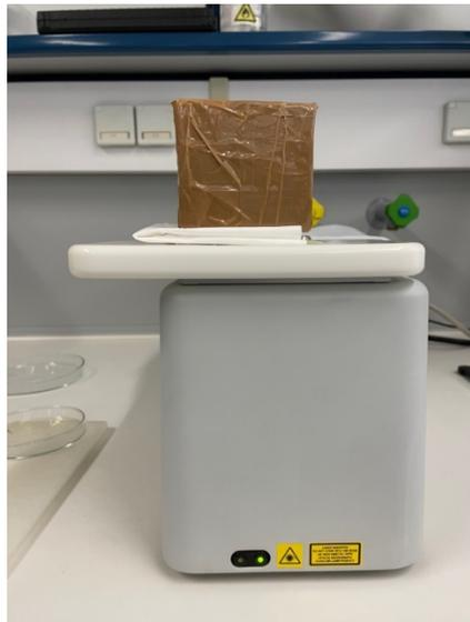
Abbildung 40: Aufbau des Schweineohrs während der Vermessung mit dem Raman-Spektroskop. Der Block beschwert die Probe, damit ein konstanter Druck auf der Probe herrscht und die Probe eben auf dem Messfenster liegt.
