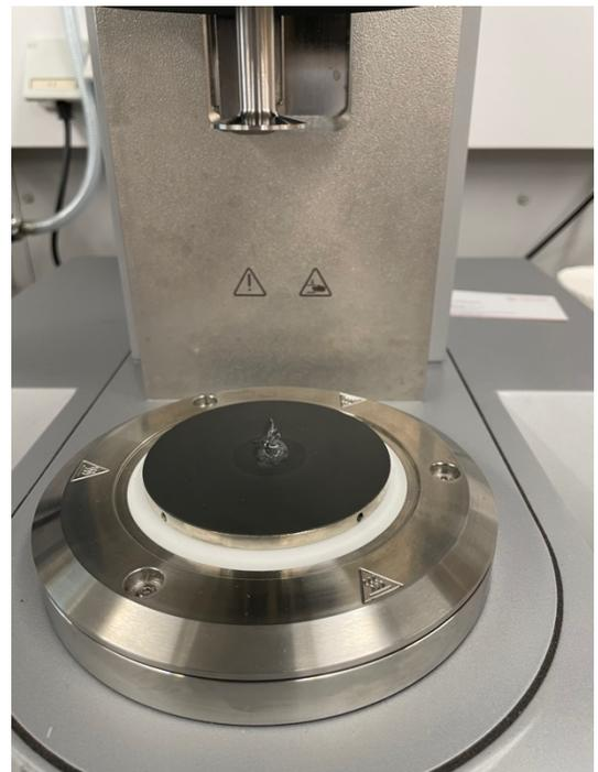
Abbildung 29: Erbsengroße Menge eines wirkstofffreien Gels aufgetragen auf der Peltier-Platte, bevor der Stift sich senkt und getrimmt wird.
