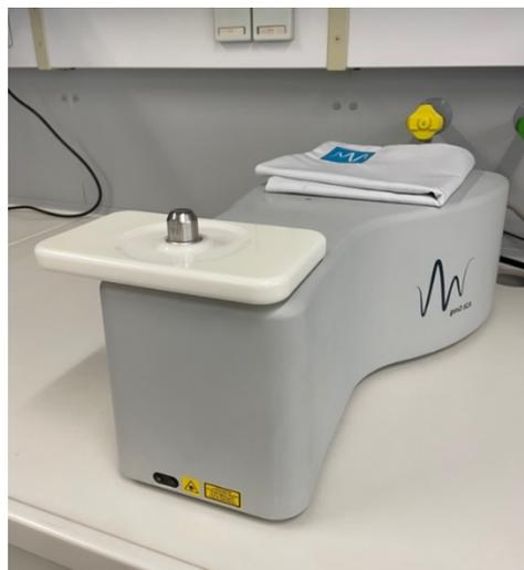
Abbildung 35: Das verwendete Raman-Spektroskop gen2-SCA der Firma RIVERD
